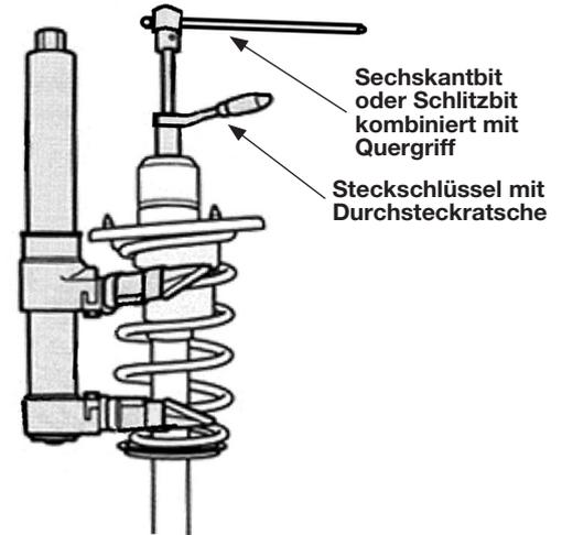
**WARNUNG: IMMER GEEIGNETEN FEDERSPANNER BENUTZEN, BEVOR DIE OBERE BEFESTIGUNGEN ENTFERNT WERDEN.**
